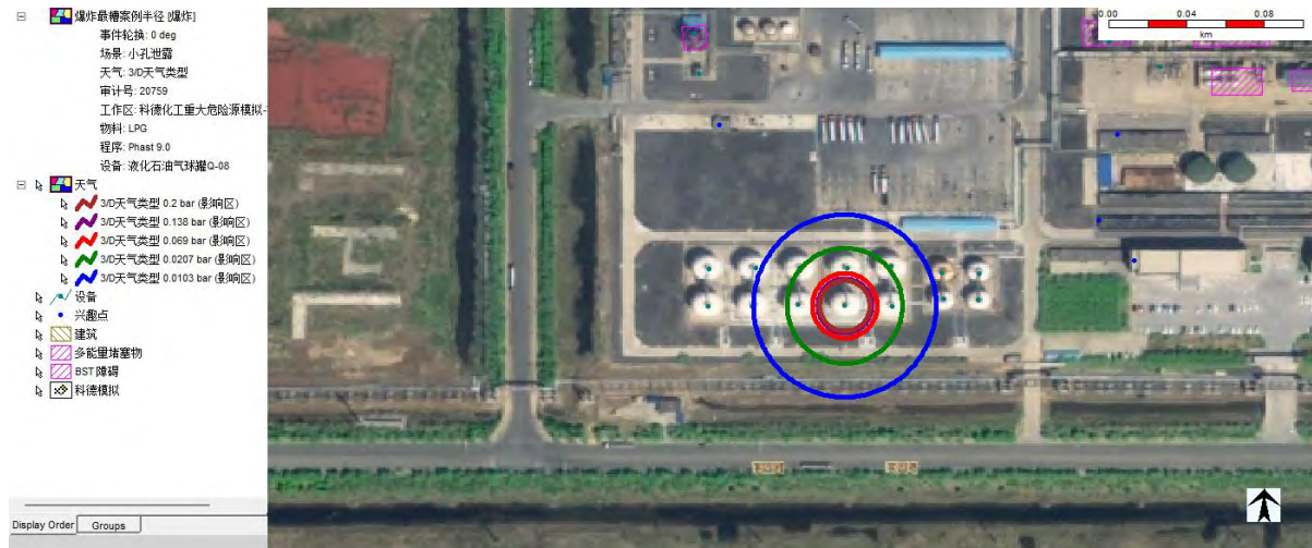
8、2000m 3 液化石油气储罐 Q-08 泄露后果图
