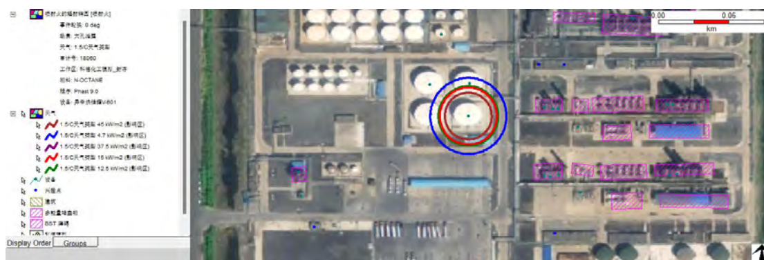
大孔泄露发生喷射火影响范围示意图
