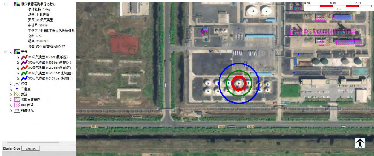
8、2000m 3 液化石油气储罐 Q-08 泄露后果图
