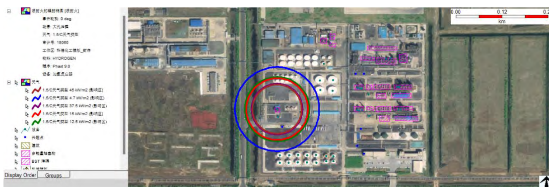
大孔泄露发生喷射火影响范围示意图
