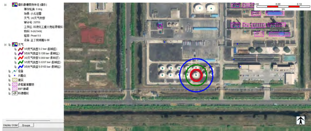
6、2000m 3 正丁烷储罐 Q-06 泄露后果图
