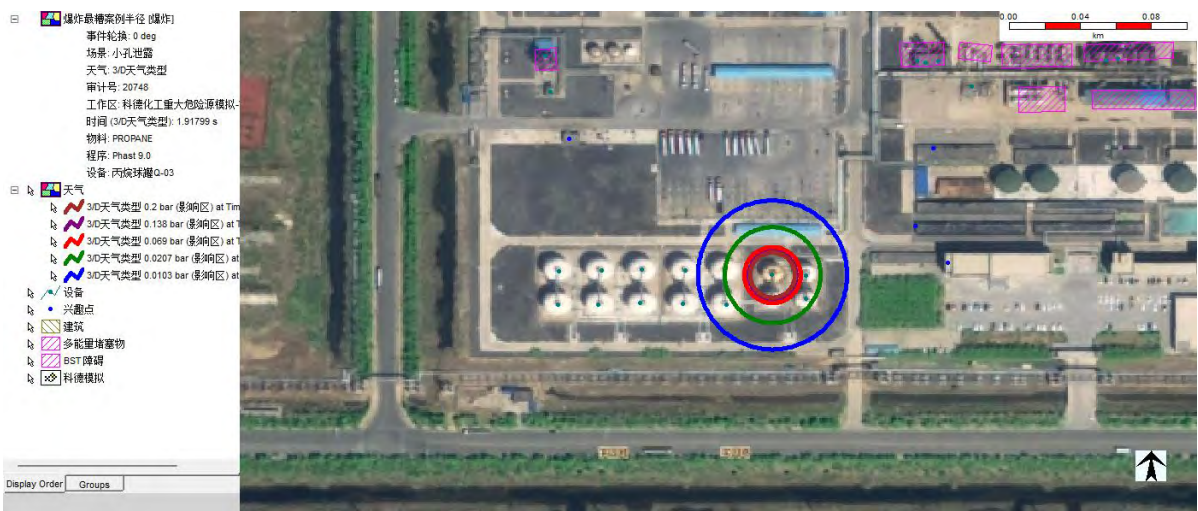
3、1000m 3 丙烷储罐 Q-03 泄露后果图
