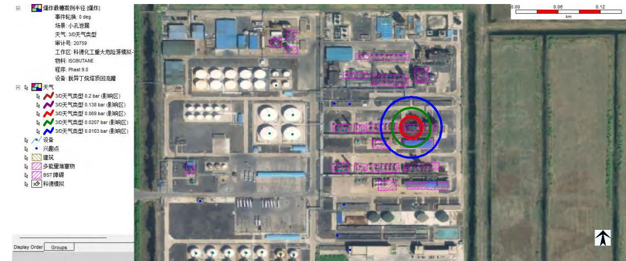
14、60 万吨/年碳四综合利用项目脱异丁烷塔顶回流罐泄露后果图
