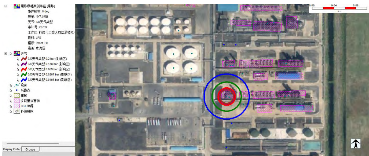
9、40 万吨/年碳四综合利用项目水洗塔泄露后果图
